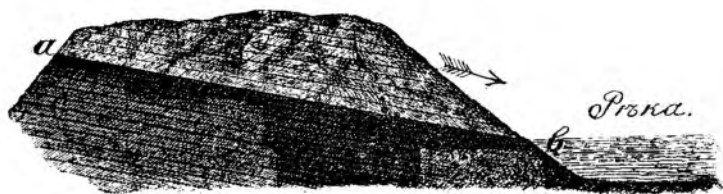
Рис. 19. Схема оползня. Линія аб изображаетъ разрѣзь поверхности, по которой происходятъ оползни.
